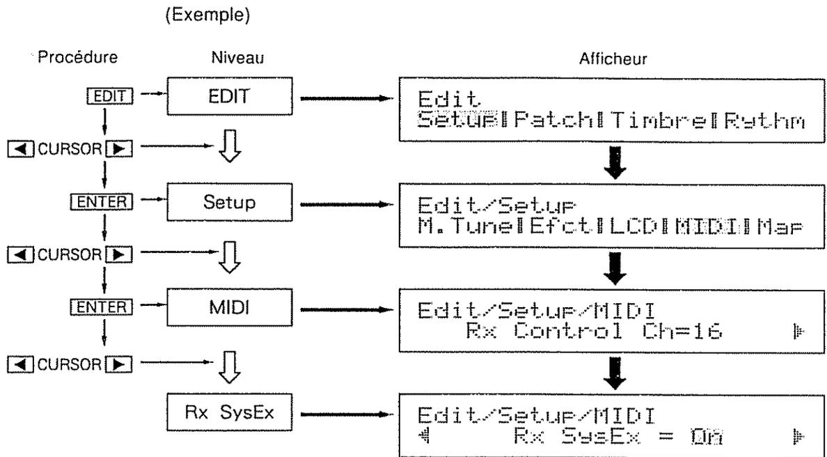
\* Les "◀" et "▶" dans l'afficheur indiquent que d'autres paramètres existent au même niveau.
